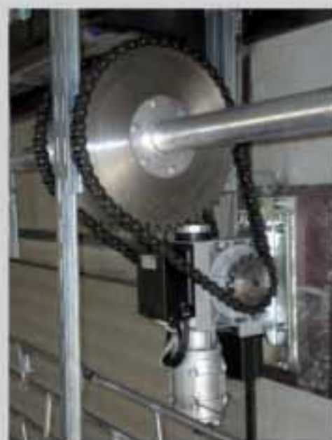
Particolare motore con rinvio a catena
